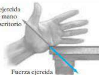
FIGURA 4-8 Si con una mano se empuja el extremo de un escritorio (el vector fuerza se muestra en azul), el escritorio empuja de vuelta contra la mano (este vector fuerza se muestra en gris, para recordar que esta fuerza actúa sobre un objeto diferente).
